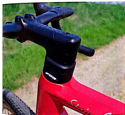
La potence FSA ACR, qui intègre le routage des gaines et durits, donne un poste épuré et rigide.
