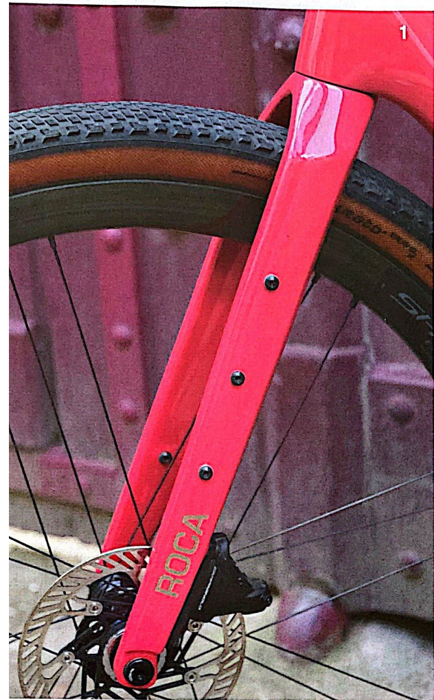
1 La fourche présente une ligne sportive, mais elle dispose des points de fixation pour ajouter des supports de bikepacking et même un porte bagages si le cœur vous en dit. 2&3 L'intégration de la câblerie est très soignée depuis l'étonnant cintre FSA jusqu'à la base arrière du cadre. La belle cassette du groupe Campagnolo Ekar offre un étagement appréciable dans toutes les situations.
