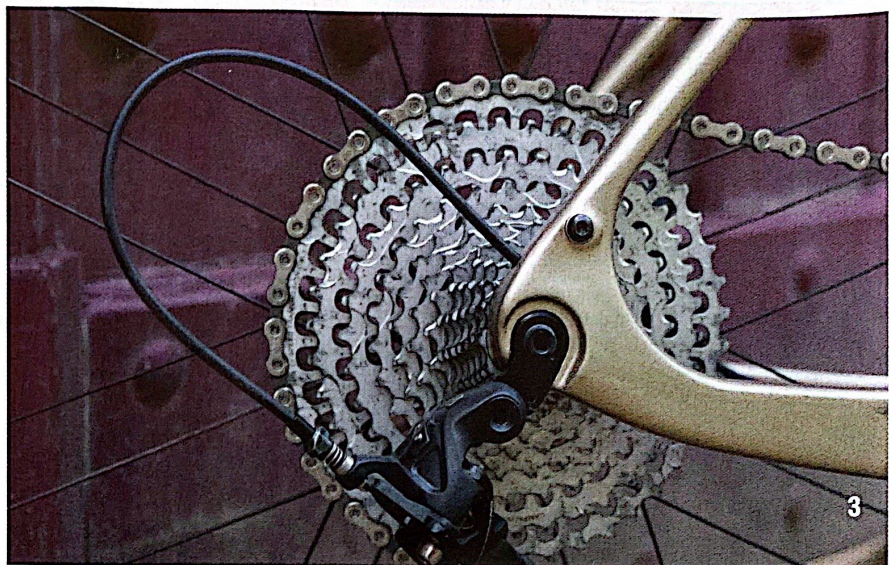
1 La fourche présente une ligne sportive, mais elle dispose des points de fixation pour ajouter des supports de bikepacking et même un porte bagages si le cœur vous en dit. 2&3 L'intégration de la câblerie est très soignée depuis l'étonnant cintre FSA jusqu'à la base arrière du cadre. La belle cassette du groupe Campagnolo Ekar offre un étagement appréciable dans toutes les situations.
